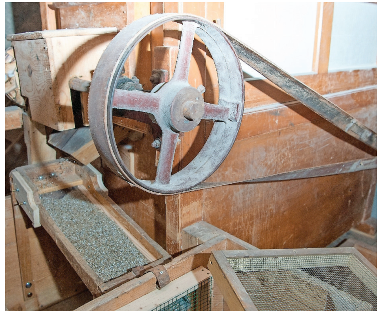
Die gequetschten Körner werden mit einer Schütteltrennvorrichtung vom Mehl getrennt und fallen in den Überlauf.
